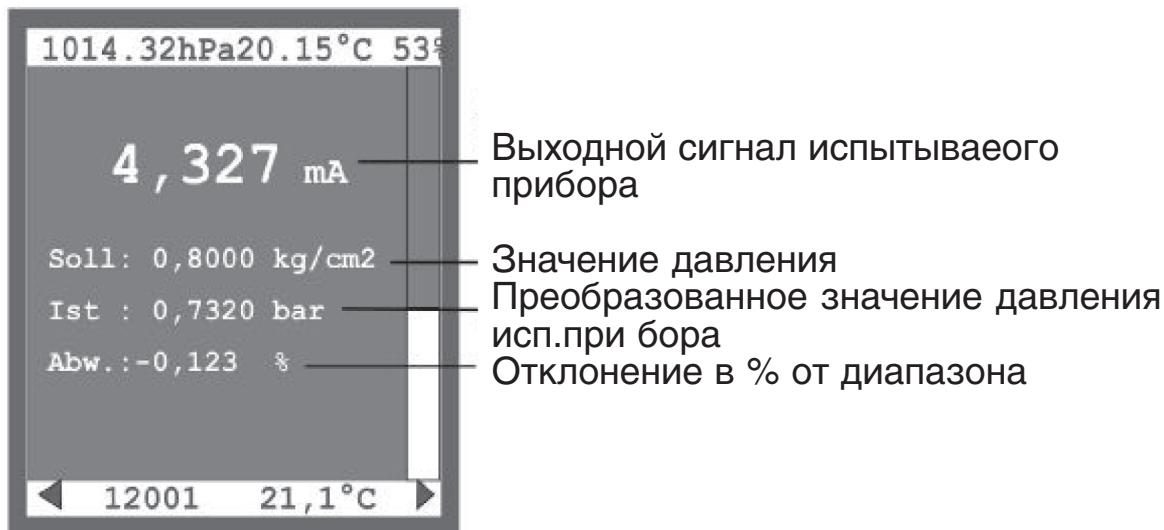
Выходной сигнал испытываемого прибора (преобразователя давления) может быть показан как в токовом (mA), так и в значение напряжения (V).
